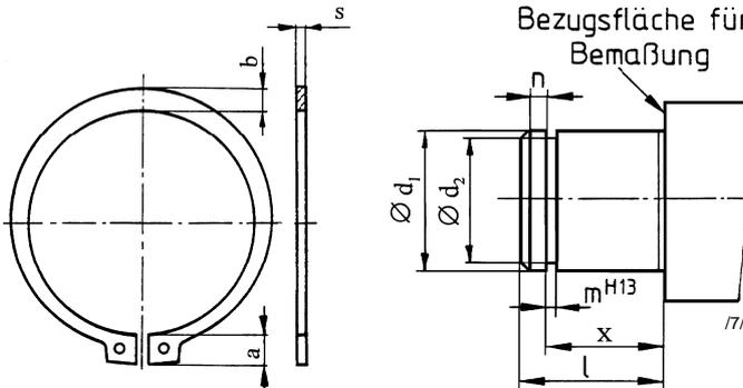
Anlagefläche des zu sichernden Teiles ist die Bezugsfläche für die Bemaßung von Sicherungsringnuten
