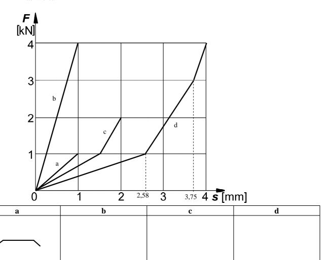
**E-FE 2** Wie bezeichnet man die Federcharakteristik des Tellerfederpaketes c und d und wo können diese Sinnvoll eingesetzt werden? Welche weiteren Federcharakteristiken kennen Sie? Nenne Sie auch hier je ein typisches Einsatzgebiet.
