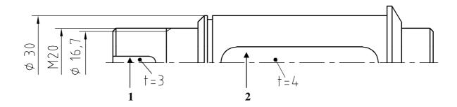
**E-AW 1** Für die oben dargestellte Welle ist die Vergleichsspannung  $\sigma_V$  an der mit **1** markierten Stelle zu bestimmen. Neben dem Torsionsmoment und dem Biegemoment sind die Quer- und Axialkräfte zu berücksichtigen. Verwendete Werte sind in Diagrammen und Tabellen zu markieren.
