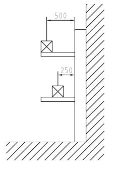
**E-VE 1** Berechnen Sie für die beiden dargestellten Fälle jeweils das maximale Biegemoment.
